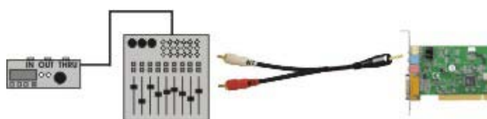
CONEXIÓN CON MESA DE MEZCLAS
